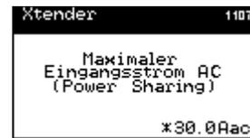
**i** Wenn bei einem gewählten Parameter das Sternchen (\*) angezeigt wird, entspricht der Wert den Fabrikeinstellungen Standarteinstellungen (Werkseinstellungen).
