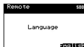
Drücken sie die Tasten „Pfeil nach oben oder nach unten „ bis die gewünschte Sprache erscheint. Bestätigen sie die Auswahl mit der Taste SET (ok) Verlassen sie die Spracheinstellung mit der Taste ESC.
