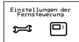
Wenn das zu ändernde Element auf der Anzeige erscheint drücken sie die Taste SET um eine Änderung vorzunehmen. Die Anzeige erscheint darauf invertiert (schwarz hinterlegt). Mit der Taste NACH OBEN oder NACH UNTEN kann der Wert geändert werden. Ist der richtige Wert eingestellt wird mit der Taste SET bestätigt oder mit der Taste ESC die Eingabe annulliert.
